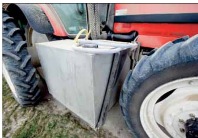
De 630 liter roestvrijstalen kunstmesttank zit hier niet in de weg. Kort monteerte deze aan het frame van de fronthef.
