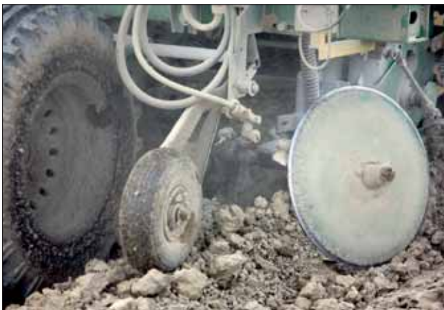
De spuitopening voor de vloeibare mest zit tussen de aanaardschijven. De mest komt zo boven in de rug, dicht bij de poters.
