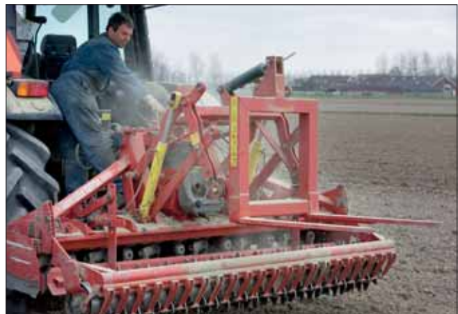
Met de aan de kopeg gemonteerde palletvork pakt Kort de kunstmestboxen op om de trekkertank bij te vullen.
